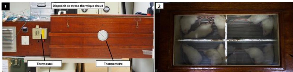
Figure 37. Dispositif utilisé pour l'exposition passive à la chaleur.
