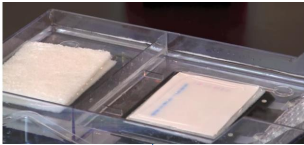
Positionner le gel d'électrophorèse
