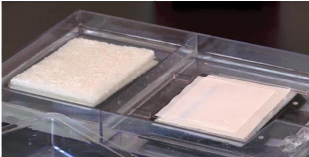
Positionner 1 membrane de nitrocellulose
