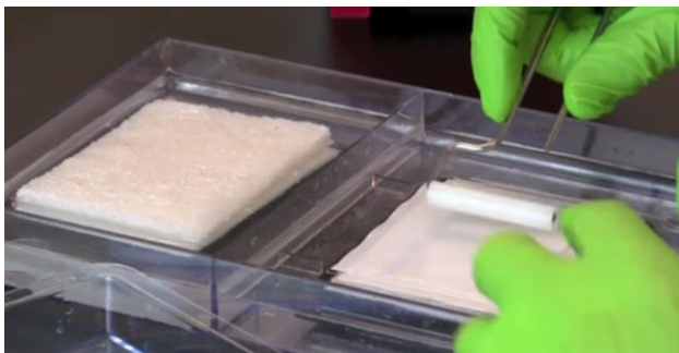
Eliminer les bulles d'air afin d'assurer un bon transfert
