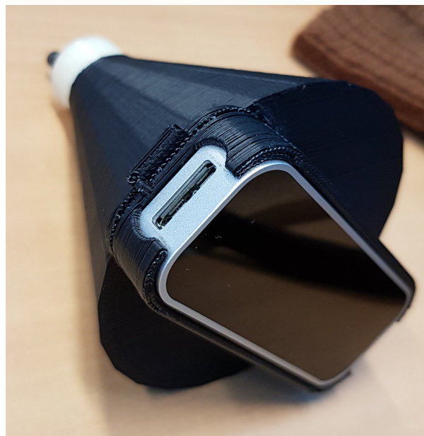
FIGURE 3.6 – Support réalisé par impression 3D permettant de fixer le Leap Motion© à une lampe
