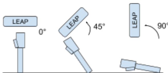
FIGURE 4.2 – Différents positionnements du Leap Motion© par rapport à la main
