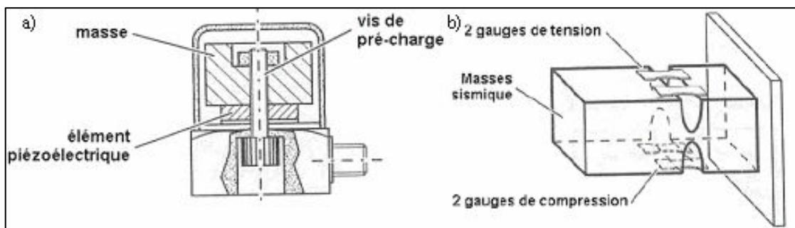
**Figure 27 :** Modèles d'accéléromètres piézoélectrique et à jauge de contraintes
