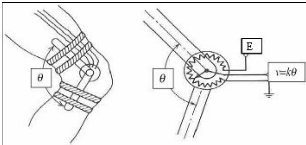
**Figure 26 : Modèle de goniomètre à potentiomètre [32]**
