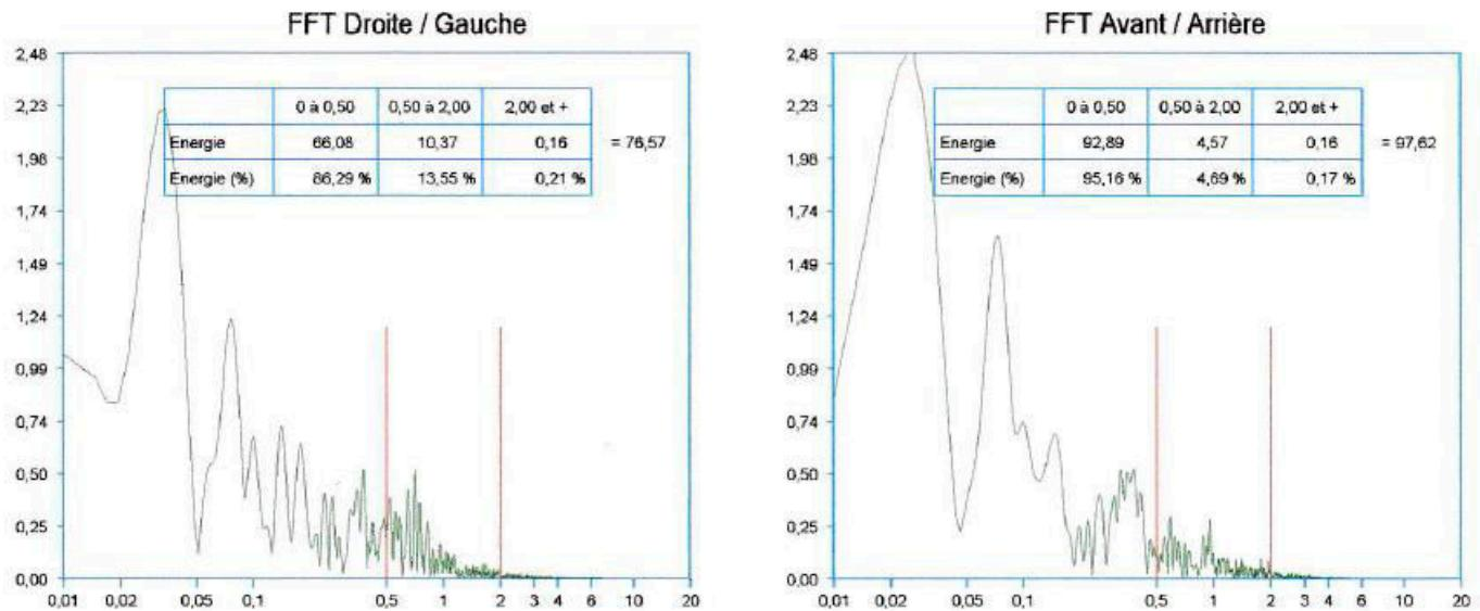
**Figure 25 :** Énergie spectrale FFT répartie selon différentes bandes de fréquence
