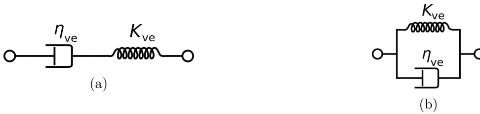
FIGURE 4.5 – Schéma des modèles viscoélastiques de (a) Maxwell et (b) Kelvin-Voigt
