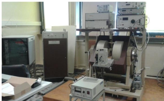
Figure 24 Un spectromètre BRUKER-EMX
