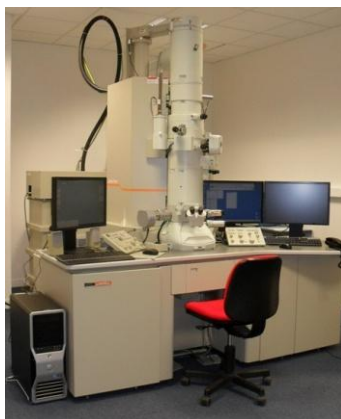
Figure 19 Microscope électronique en transmission JEOL JEM 2010
