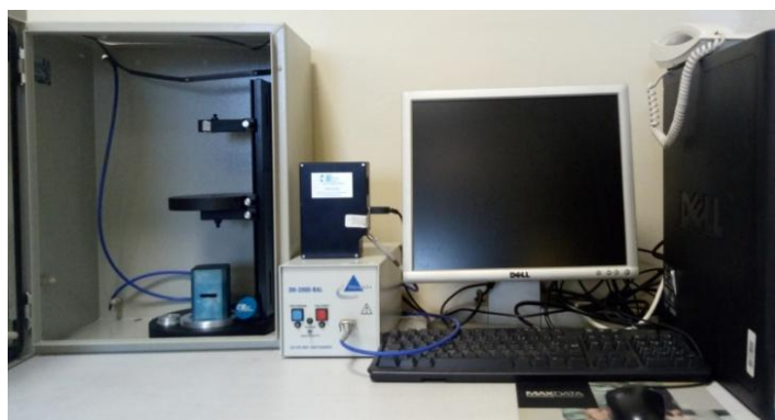
Figure 21 Un spectrophotomètre à haute résolution (Ocean Optics HR4000)
