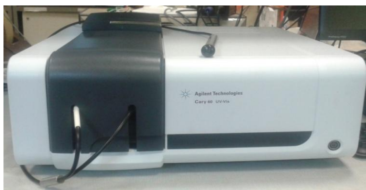
Figure 22 Un spectrophotomètre UV-visible (Cary 60 UV-Vis)
