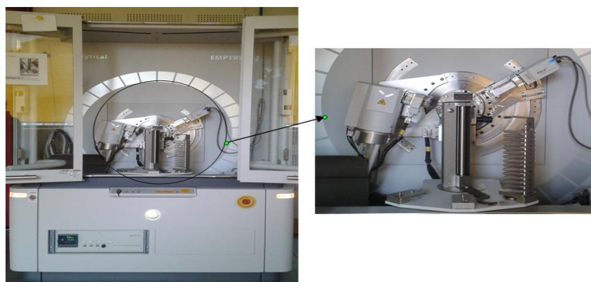
Figure 16 Un diffractomètre X'pert MPD PRO de PANalytical
