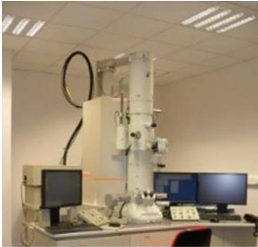
Fig. 2.12 JEOL JEM 2100 HR TEM (Jeol Ltd.) (IMMM- Le Mans)
