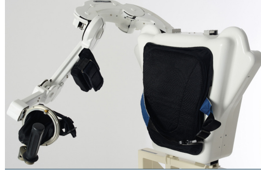
(b) ALEx, Wearable Robotics Exosquelette actionné de membre supérieur pour la réhabilitation. De nombreux modes de contrôle, dont la compensation gravitaire, peuvent être implémentés.
