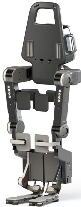
(a) Atalante V4, Wandercraft Exosquelette actionné de membre inférieur et tronc pour la réhabilitation à la marche
