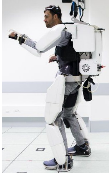
FIGURE 1.2 – Exemple d'exosquelette de corps complet piloté par une interface cerveau-machine
