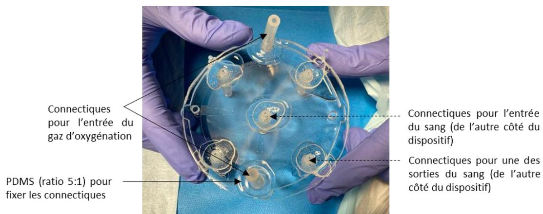
Figure 3.20. Ce dispositif composé d'une seule structure tri-couche montre la première technique d'intégration des connectiques fluidiques : les connectiques pour les entrées et les sorties du sang et du gaz d'oxygénation sont directement intégrées dans les trous percés préalablement dans les modules de PDMS puis fixées à l'aide d'un dépôt, autour de ces connectiques, d'une solution de PDMS préparé avec un ratio prépolymère/réticulant de 5:1 en masse.
