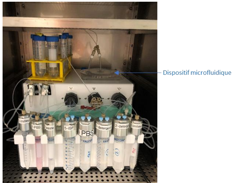
Figure 4.11. Une image du contrôleur de pression Fluigent (MFCS™) connecté à un dispositif microfluidique (uniquement partie module de sang) installé à l'intérieur d'un incubateur pendant le test d'endothélialisation des capillaires sanguins.
