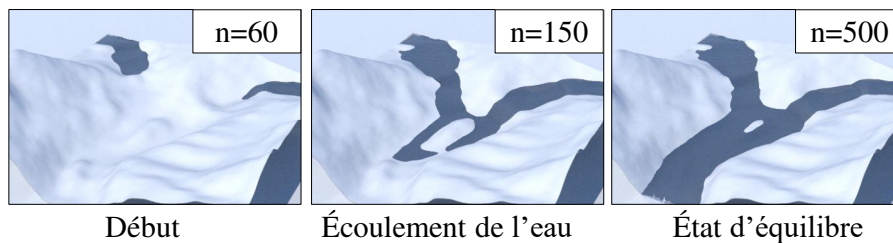
Figure 86 : Exemple de la simulation en eau peu profonde sur le terrain initial à différent moment ( n = 60, 150, 500 ).
