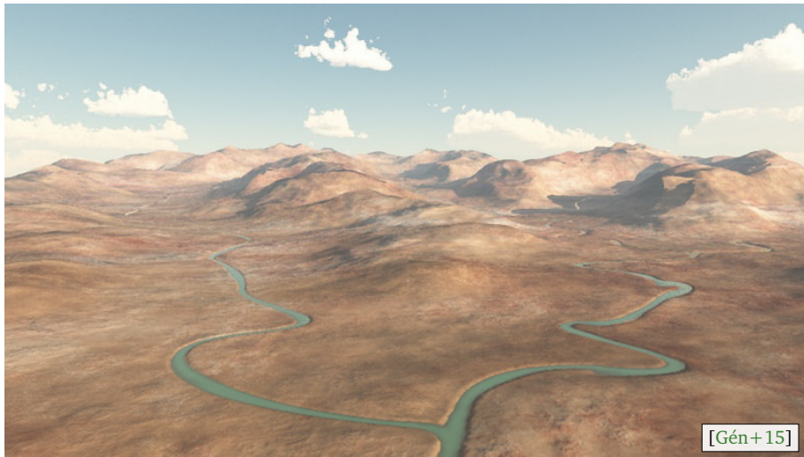
Figure 57 : Pour mettre de la matière jusqu'à une certaine hauteur, l'opérateur de remplissage ajoute la différence entre la hauteur souhaitée et la hauteur actuelle. Il est adapté pour ajouter une surface plane d'eau mais ne permet pas de créer un écoulement réaliste animé.
