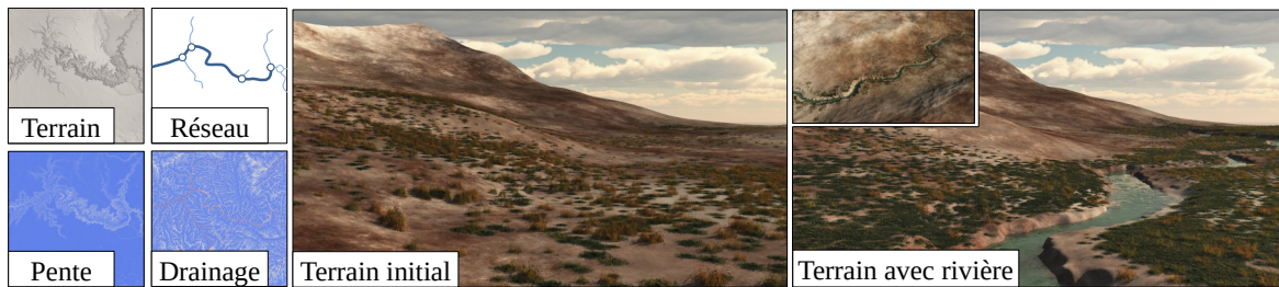
Figure 88 : À partir d'un terrain nu, notre méthode calcule la pente et l'aire de drainage pour générer automatiquement un graphe de rivières qui est amplifié procéduralement en une rivière détaillée et animée. Dans le cas présent, sur une longueur de 4.266 km, à partir de 63k primitives de terrain et 42k d'eau.
