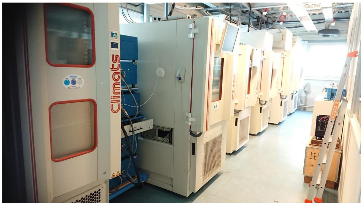
Fig. 2.1 Salle des essais, constituée de six enceintes Climats et de multiples potentiostats.
