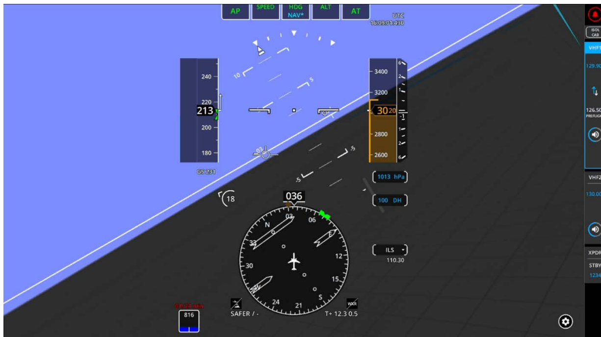
FIGURE 59 – VUE DU PFD AVEC UN TEMPS DE VOL RESTANT <30MIN (D'APRÈS CARBURANT) (Indication du temps de vol en rouge au-dessus de la gauge de carburant)
