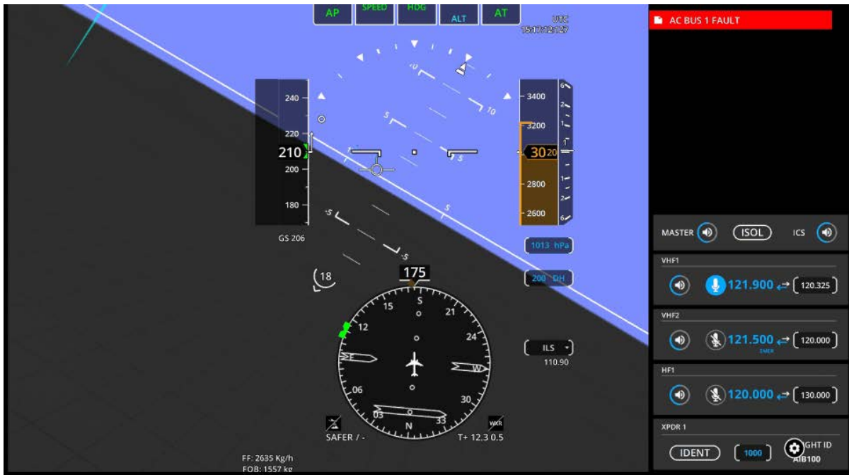
FIGURE 49 – VUE DU PFD AVEC UN MESSAGE D'ERREUR INDIQUANT UNE PANNE ÉLECTRIQUE « AC BUS 1 FAULT » (EN ROUGE EN HAUT À DROITE) PENDANT L'EXPÉRIMENTATION STEP 2
