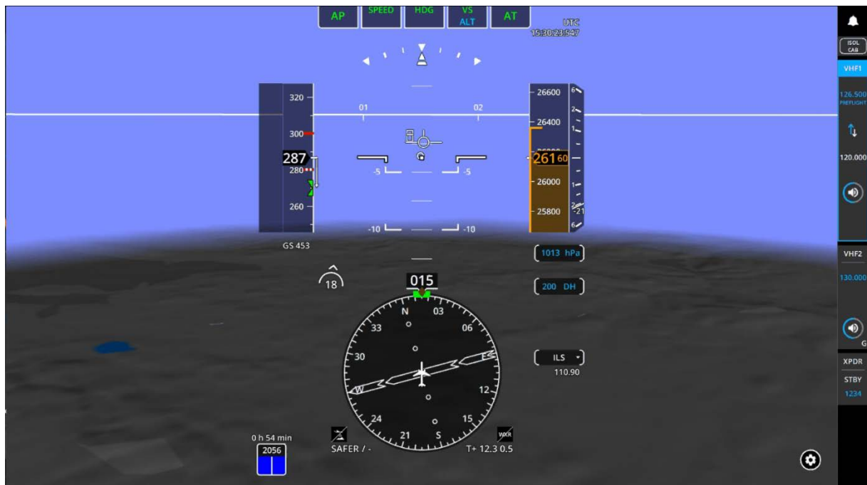
FIGURE 58 – VUE DU PFD DANS LA PHASE STEP 3 DE L’EXPÉRIMENTATION. (Avec une gauge indiquant la quantité de carburant restant – en bleu – en plus de la valeur en kg)
