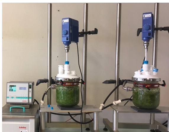
Figure 58 : Montage en série de réacteurs (Mac Technologie) pour l'extraction par macération ou par EAE
