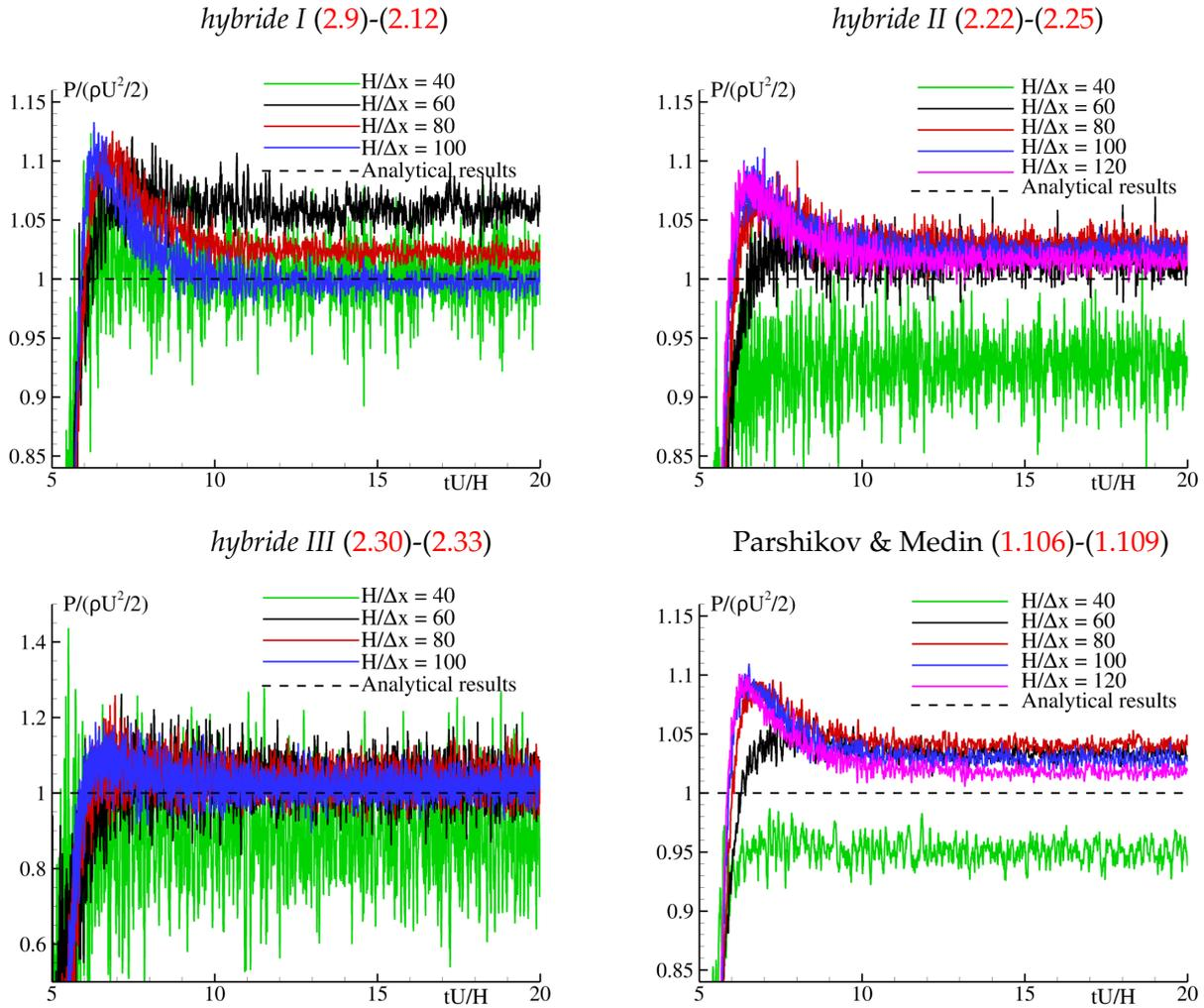
FIGURE 3.11 – Jet fluide impactant une plaque plane en 2D (avec particules fantômes). Evolution de la pression au point d'arrêt pour les quatre schémas testés et pour quatre discrétisations spatiales.
