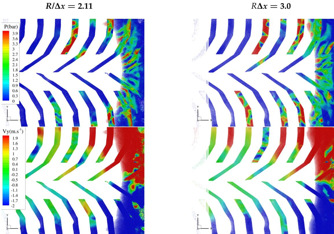
FIGURE 6.14 – Champs solutions obtenus pour le pneumatique 2 à  $t = 24.75ms$  en vue de dessus pour  $R/\Delta x = 2.11$  (à gauche) et  $R/\Delta x = 3.0$  (à droite). Haut : champ de pression. Bas : champ de vitesse transversale.
