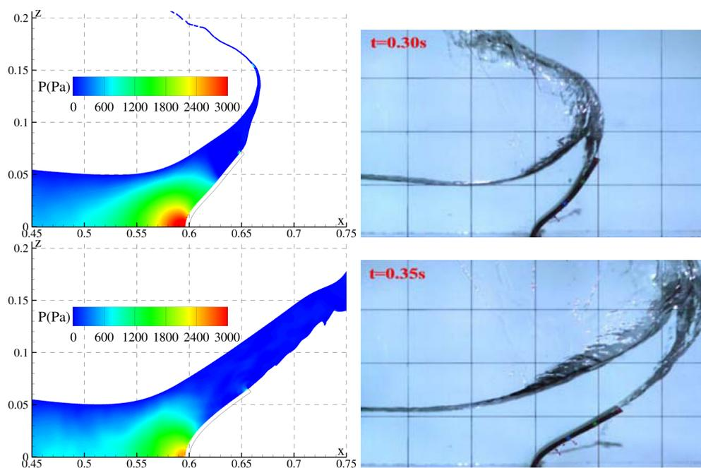
FIGURE 5.19 – Dam-break impactant une plaque déformable en 2D avec  $H_0 = 0.3m$ . Comparaison qualitative des résultats obtenus entre expérience et simulation (Aster avec schéma CSS et  $L/\Delta x = 180$ ).
