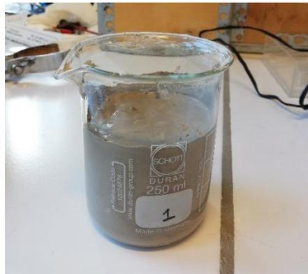
Figure II-8. Échantillon de kaolinite et d'eau dé-ionisée.
