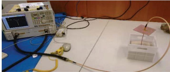
Figure I-27- Dispositif de mesure pour la caractérisation des mélanges de sol et d'eau avec différentes quantités de NaCl à l'aide d'une sonde monopole [67].
