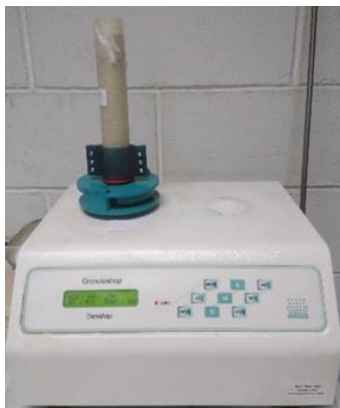
Figure II.28 (a) Image du dispositif Densitap de Granuloshop et (b) Schéma de l'évolution de la densité avec le temps
