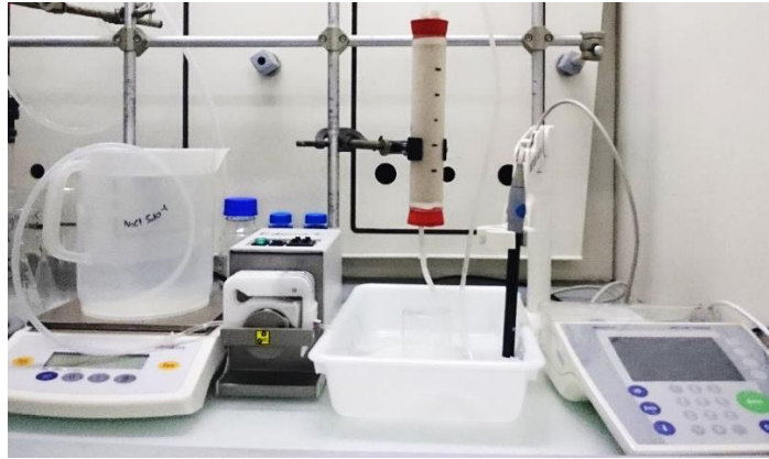
Figure II.27 a) Schéma et b) Photographie du dispositif expérimental des expériences de percolation à l'échelle de la colonne de laboratoire
