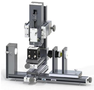
Figure II.15 (a) Image du Tracker de Teclis Scientific et (b) Profil schématisé d'une goutte à l'équilibre analysée par la méthode de la goutte pendante
