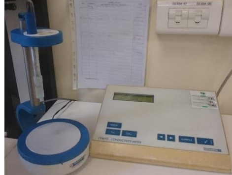
Figure II.11 (a) Image du pH-mètre SevenCompact de Mettler Toledo et (b) Image du conductimètre CDM92 de Radiometer Copenhagen
