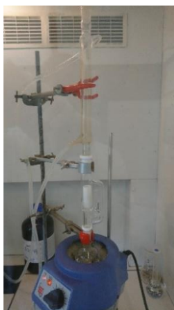
Figure II.24 (a) Photographie et (b) schéma du montage expérimental de l'extracteur de Soxhlet
