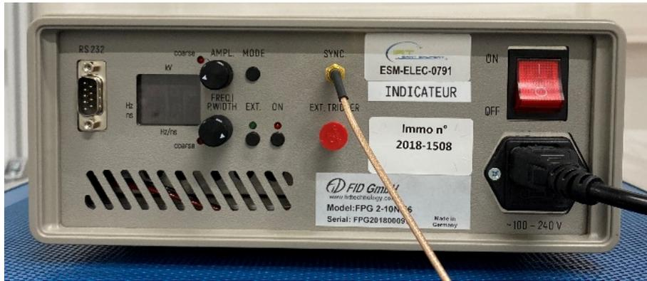
Figure 4.3 : Générateur d'impulsions FPG 2-10NM6
