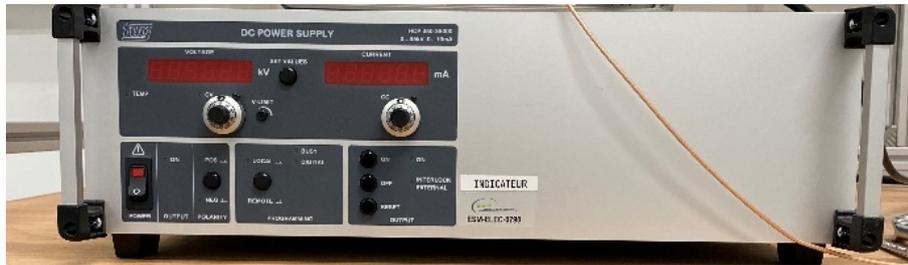
Figure 4.2: Générateur de polarisation HCP 35-35000
