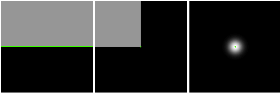
(a) Bord idéal dans une image synthétique (b) Coin idéal dans une image synthétique (c) Blob idéal dans une image synthétique
