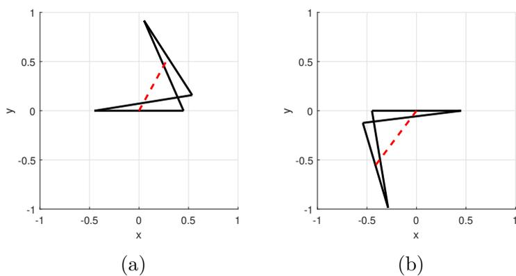
FIGURE 4.6 – Mécanisme en X en configuration normale (a) et retournée (b).
