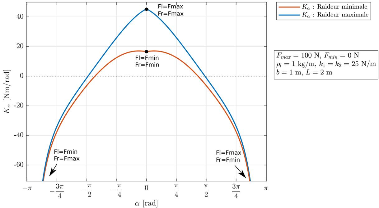
FIGURE 3.4 – Raideur atteignable pour un mécanisme en X.
