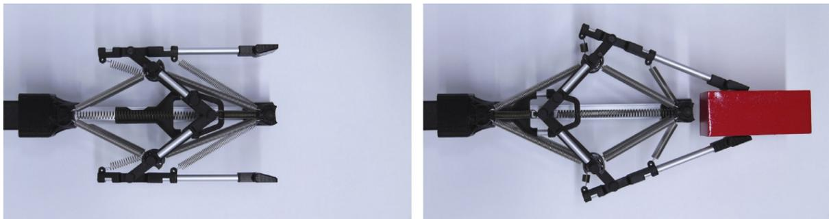
FIGURE 1.22 – Pince ouverte et fermée [SBZ17].
