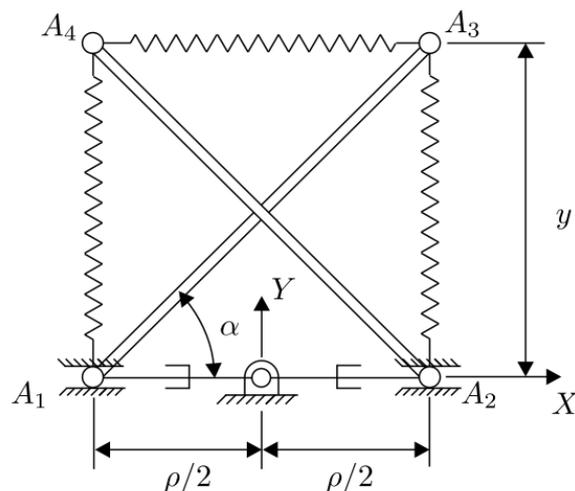
FIGURE 1.23 – Mécanisme de tensegrité plan à 1 DDL [Ars06].
