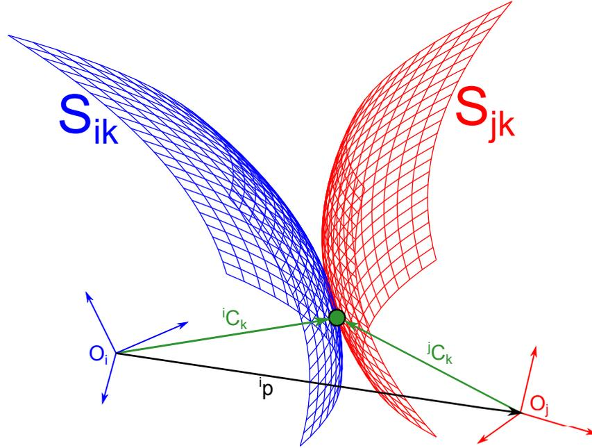
FIGURE 2.9 – Représentation de deux surfaces  $S_{ik}$  et  $S_{jk}$  en contact au point  $C_k$ .
