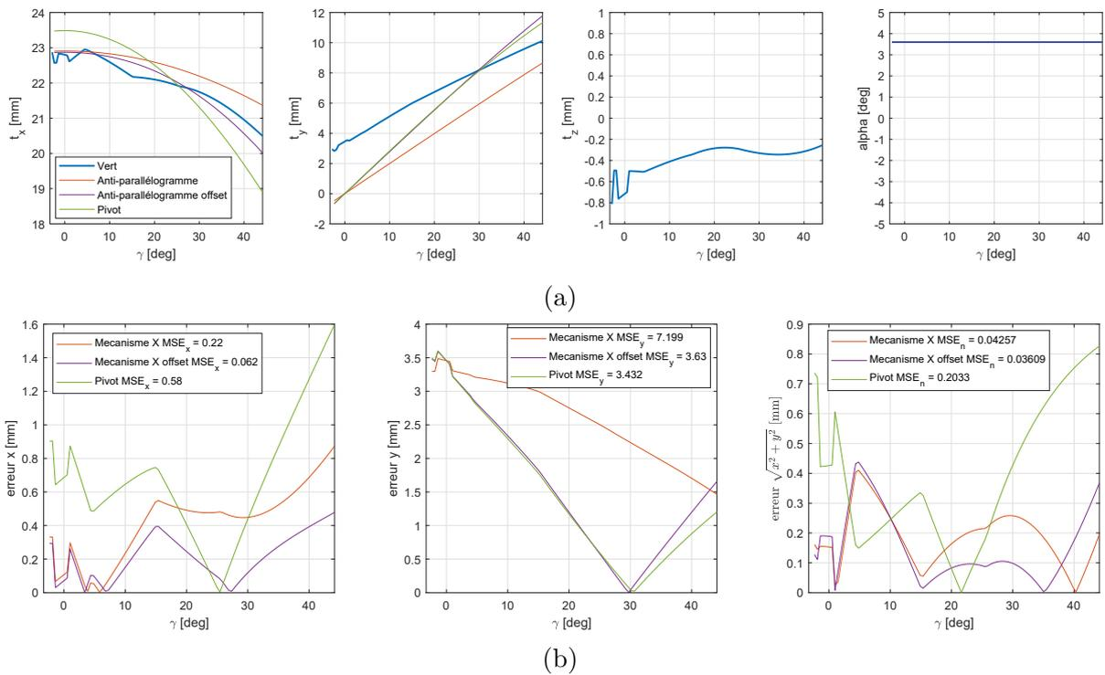
FIGURE 2.16 – (a) Évolution de la position entre les deux vertèbres  $V_7$  et  $V_8$  du *Gyps Fulvus* pour  $\gamma \in [-2.8^\circ, 44.1^\circ]$  et  $\beta = 0^\circ$  et évolutions des trois mécanismes optimaux pour la même plage angulaire. (b) Erreur en x, en y et en norme, par rapport à la trajectoire de la vertèbre  $V_8$ , pour les trois mécanismes optimaux obtenus.
