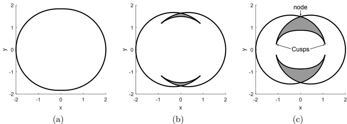
FIGURE 4.4 – Limites de l'espace de travail pour  $L = 1$  et  $b = 2/5$  (a),  $b = 2/3$  (b),  $b = 9/10$  (c). Les zones à quatre solutions sont remplies en gris.
