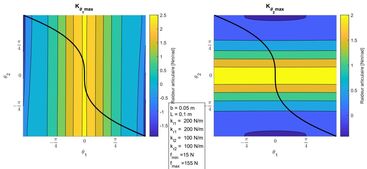
FIGURE 4.21 – Raideur articulaire maximale pour la stratégie strut-routed.
