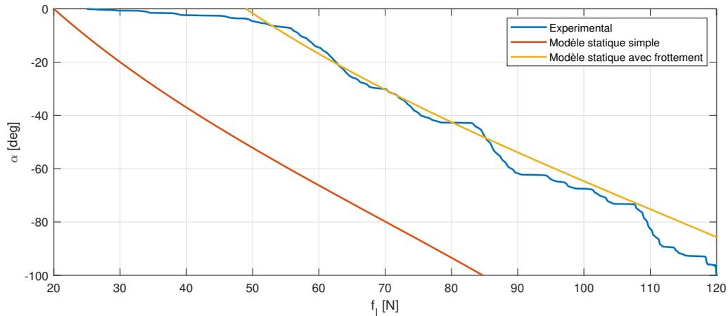
FIGURE 3.12 – Réponse angulaire du mécanisme à l’application d’un effort croissant en boucle ouverte (bleu), comparaison avec le modèle statique (rouge) et modèle statique prenant en compte le frottement dans les actionneurs (jaune).
