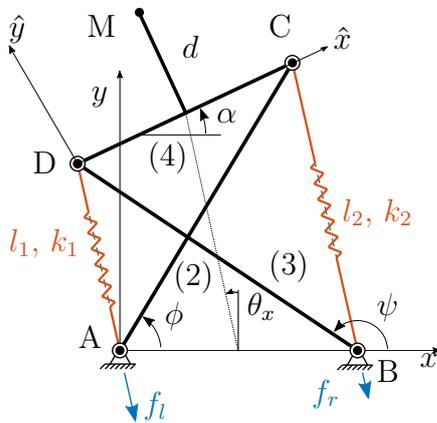
FIGURE 3.1 – Paramétrage d'un mécanisme en X.
