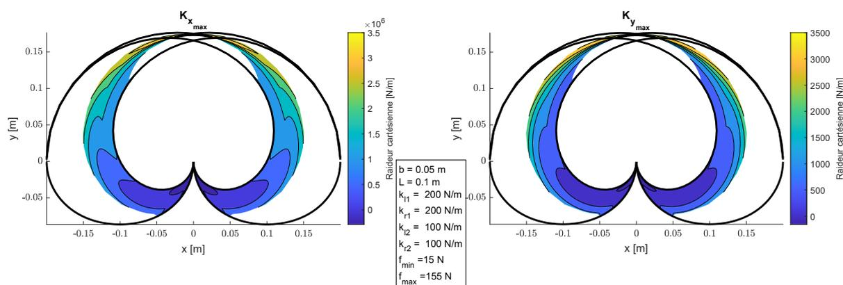
FIGURE 4.19 – Espace de travail accessible et raideur cartésienne maximale pour la stratégie side-routed.
