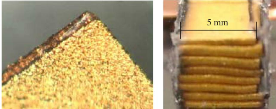
FIGURE 1.5 – Empilement d'élastomères conducteurs (or et silicone) [Maz+12].
