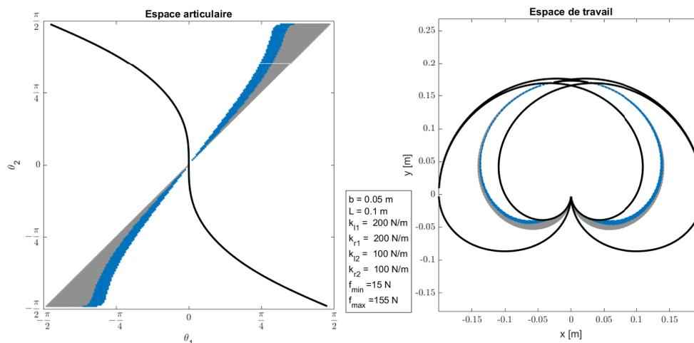
FIGURE 4.14 – Espace de travail atteignable dans l'espace articulaire (gauche) et l'espace cartésien (droite). La zone bleue correspond à la zone atteignable avec les efforts  $F_{min}$  et  $F_{max}$  prescrit, et la zone grise le WFW pour  $F_{max}$  non borné.
