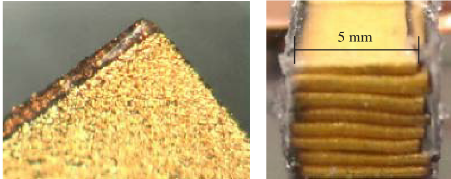
FIGURE 1.5 – Empilement d'élastomères conducteurs (or et silicone) [Maz+12].
