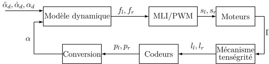
FIGURE 3.10 – Boucle de commande
