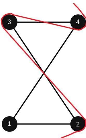
FIGURE 14 – Passage du câble en strut-routed
