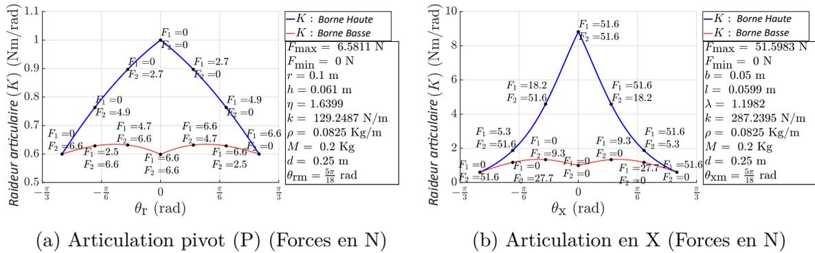
FIGURE 3.7 – Tracé des frontières de la raideur correspondant à la conception optimale des deux mécanismes pour un WFW donné de  $[-\frac{5\pi}{18}, \frac{5\pi}{18}]$ , des raideurs en 0 et aux frontières de  $K_0 = 1 \text{ Nm/rad}$ ,  $K_1 = 0,6 \text{ Nm/rad}$  et une charge appliquée de :  $M = 0.2 \text{ kg}$ ,  $d = 0.25 \text{ m}$ .
