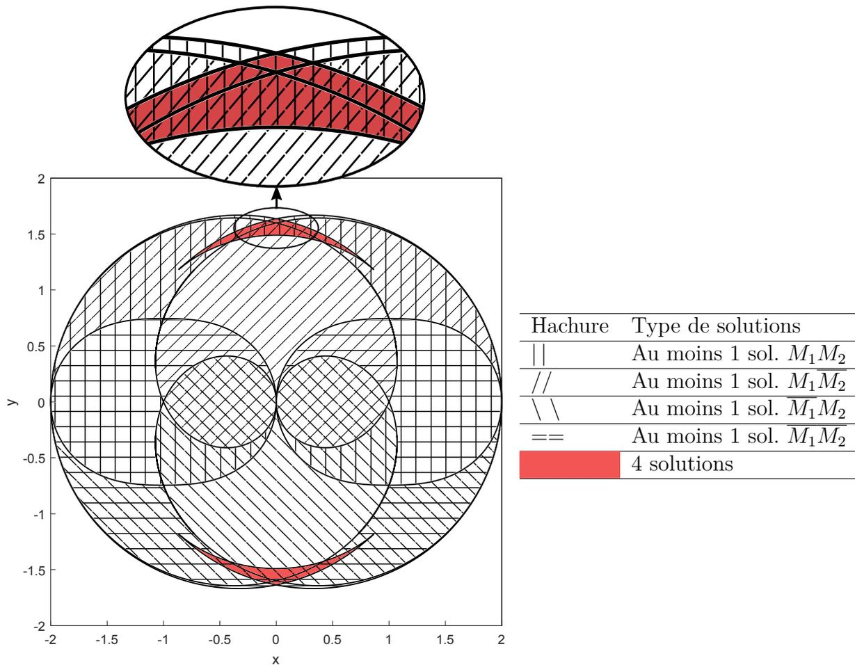
FIGURE 4.7 – Régions de l'espace de travail avec un nombre et type différent de solutions ( $L = 1$ ,  $b = 2/3$ .  $\overline{M}_i$  (respectivement  $M_i$ ) signifie que le mécanisme  $i$  est en configuration basse (respectivement haute).
