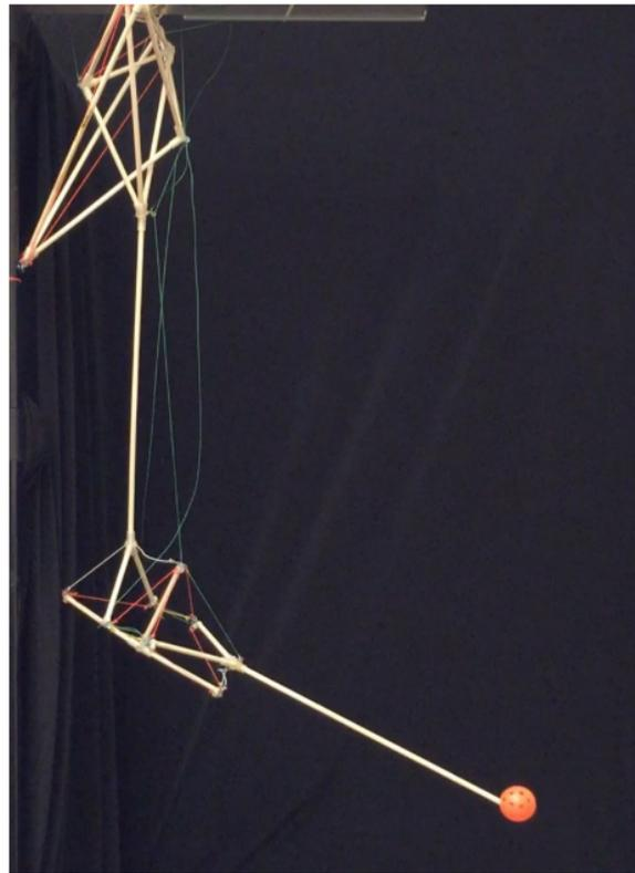
FIGURE 1.4 – Bras manipulateur utilisant le principe de tensegrité [Les+16].
