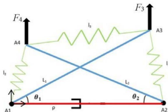
FIGURE 1.24 – Mécanisme de tensegrité plan à 1 DDL [WC17].
