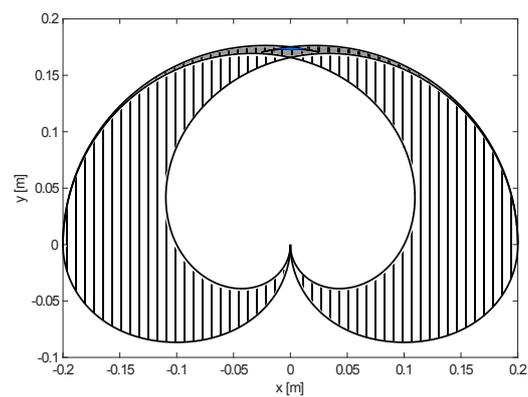
FIGURE 4.10 – Espace de travail du manipulateur avec les dimensions données. Les zones non-vides sont remplies par des lignes verticales. Le nombre de solutions est défini par la couleur de fond : blanc=1, gris=2, bleu=4.
