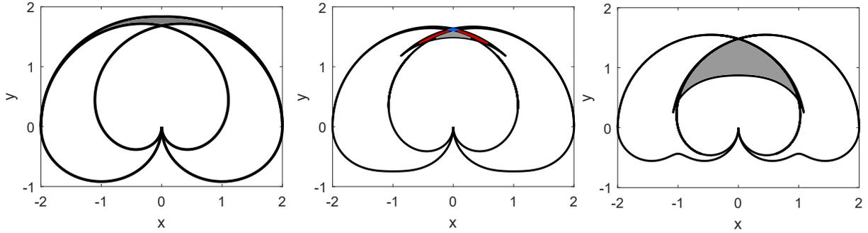
FIGURE 4.8 – Limites de l'espace de travail quand  $-\pi/2 < \theta_1, \theta_2 < \pi/2$ , et pour  $L = 1$ ,  $b = 2/5$  (gauche),  $b = 2/3$  (centre),  $b = 9/10$  (droite). La partie non vide est remplie avec des hachures verticales. Le nombre de solutions est défini par les couleurs de remplissage : pas de couleur=1, gris=2, rouge=3 and bleu=4.
