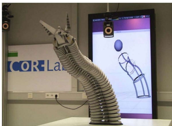
FIGURE 1.2 – Prototype BHA imitant une trompe d'éléphant [RS13].
