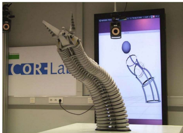
FIGURE 1.2 – Prototype BHA imitant une trompe d'éléphant [RS13].
