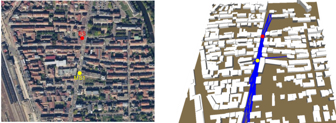
FIGURE 104 : APERÇU DE L'ENVIRONNEMENT RÉEL DE PROPAGATION (À GAUCHE) ET DES RAYONS SIMULÉS PAR STARLIGHT POUR LE LIEN BS-MS1
