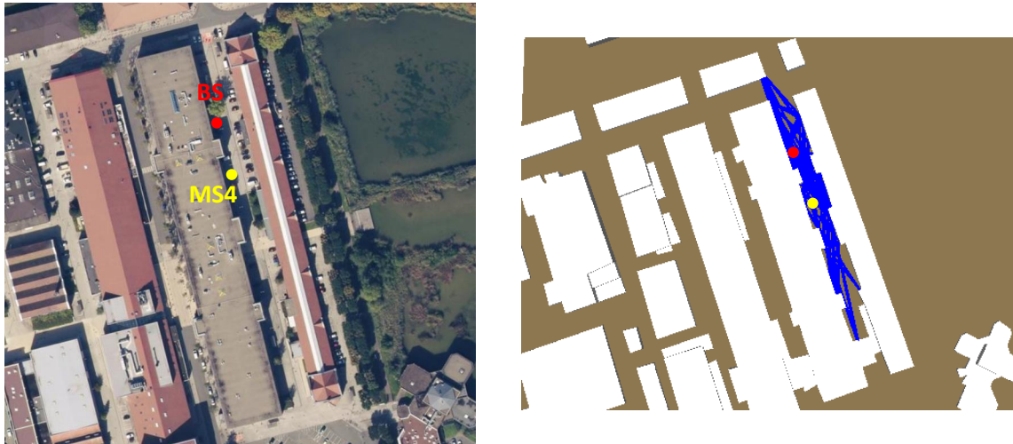
FIGURE 101 : APERÇU DE L'ENVIRONNEMENT RÉEL DE PROPAGATION (À GAUCHE) ET DES RAYONS SIMULÉS PAR STARLIGHT POUR LE LIEN BS-MS4
