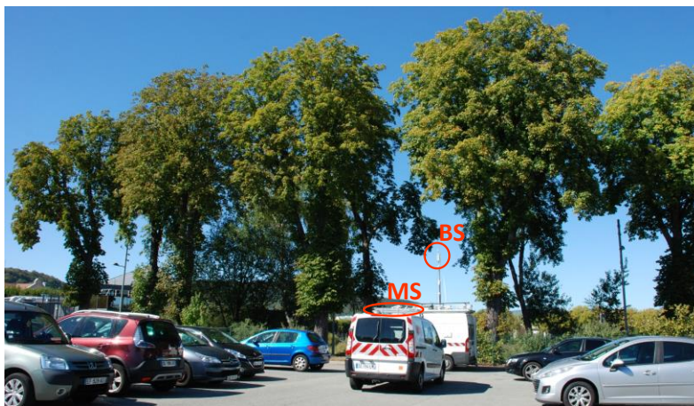
FIGURE 49 : ILLUSTRATION D'UN LIEN BS-MS SUR LE PARKING POUR BS A 5M
