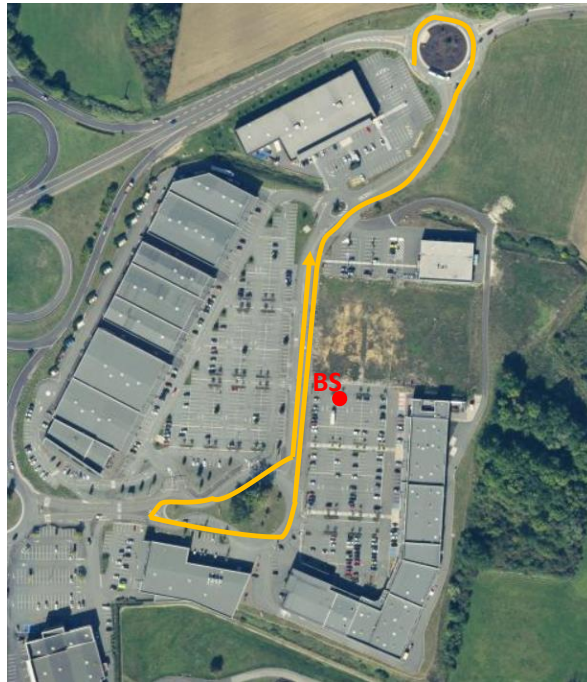
FIGURE 60 : APERÇU DE L'ENVIRONNEMENT DE PROPAGATION AVEC POSITION DU BS ET PARCOURS DE LA MS
