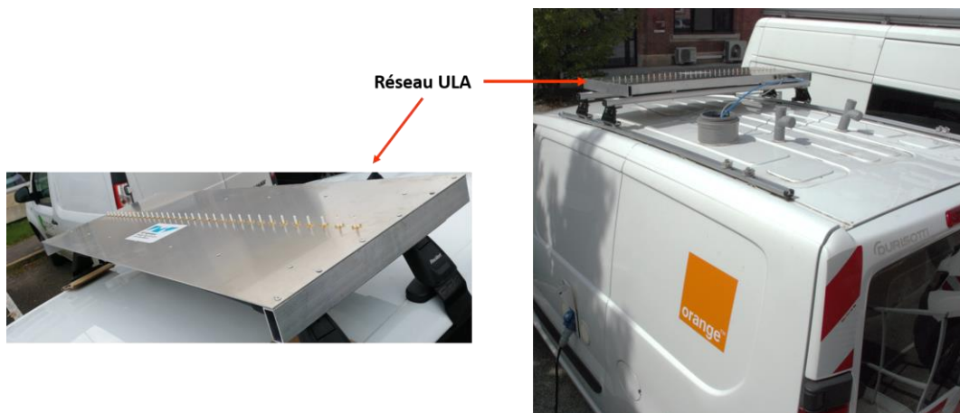
FIGURE 46 : RESEAU LINEAIRE D'ANTENNES MONTE SUR LE TOIT DU VEHICULE DE MESURES
