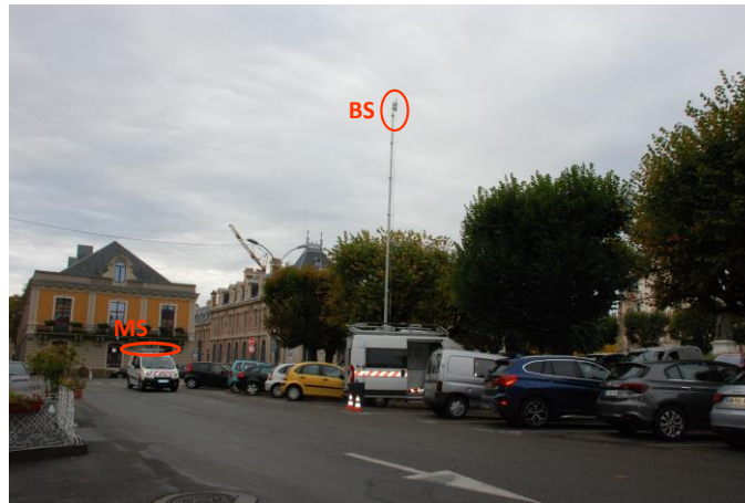
FIGURE 53 : ENVIRONNEMENT DE MESURES URBAIN AVEC BS À 12 MÈTRES ET MS
