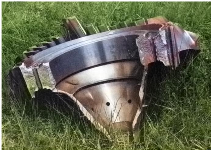
FIGURE 4.16 – Photo du disque de soufflante en TA6V à l'origine de l'accident aérien survenu à Pensacola (Floride, USA), le 6 juillet 1996 [66].
