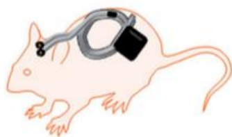
Figure 32 : Dispositif d'implant EEG placé sur le crâne de la souris et relié à un boîtier d'enregistrement en sous cutané, au niveau dorsal.
