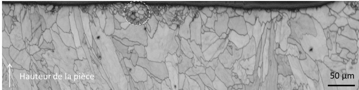
Figure 3.16. Particule de poudre (cercle pointillé) partiellement fondue observée au MEB au niveau de la surface supérieure de la coupe longitudinale d'un monocordon
