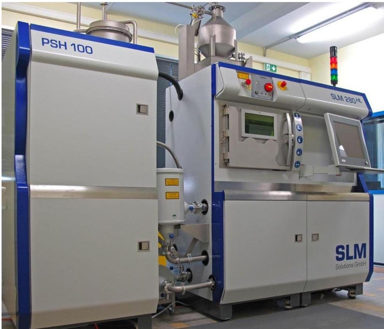
Figure 3.2. Machine SLM 280 HL de la plateforme Pro3D [Pro3D 2020]
