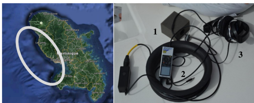
FIG. 2.24 – Présentation de la zone d'étude et du matériel. 1 : Hydrophone (dans sa protection), 2 : Enregistreur, 3 : Casque audio.
