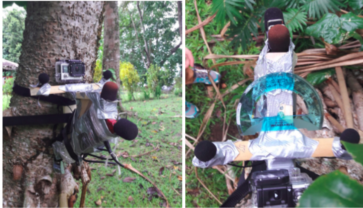
FIG. 2.23 – Protocole réalisé pour la détection de source en milieu terrestre.
