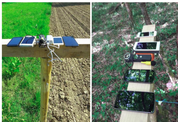
FIG. 2.9 – Téléphones utilisés ainsi que l'enregistreur type "Zoom". Le cinquième téléphone est utilisé pour prendre la photo. Photographie tirée du rapport de recherche Poupard et al. (2018c).
