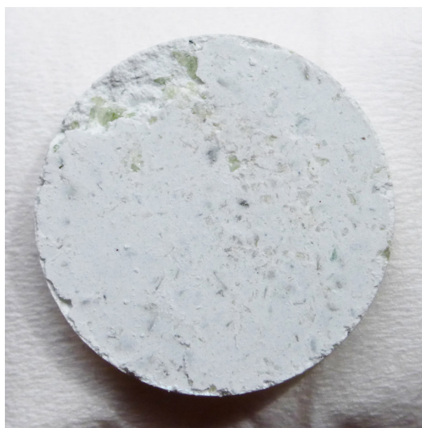
Figure IV.12 – Pastille compressée obtenue à partir d'un mélange contrôlé de 60% de serpentine (<100 \mu\text{m} ) et 40% d'olivine (<1 mm). Le diamètre de la pastille est de 1,3 cm.
