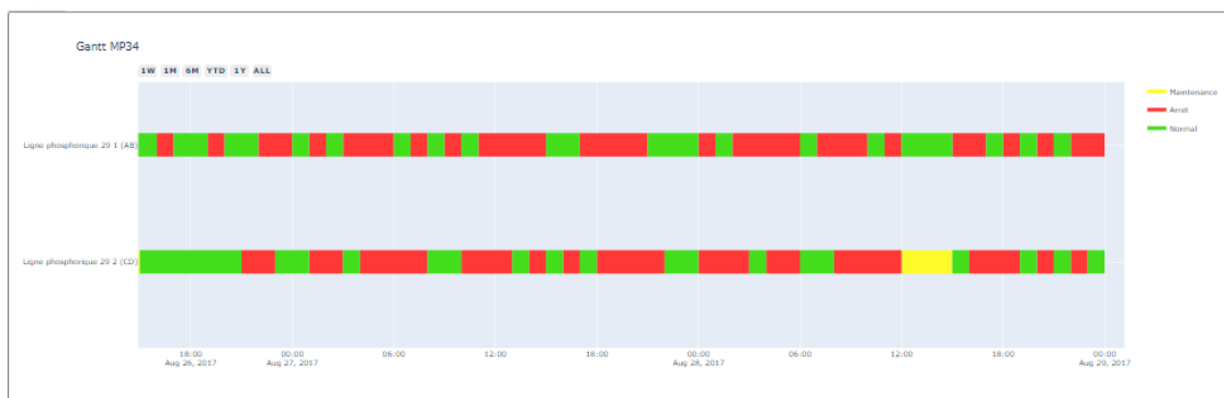
Figure 30 : zoom sur des arrêts de production non programmés sur des lignes d'acide phosphorique 29% de l'entité MP34
