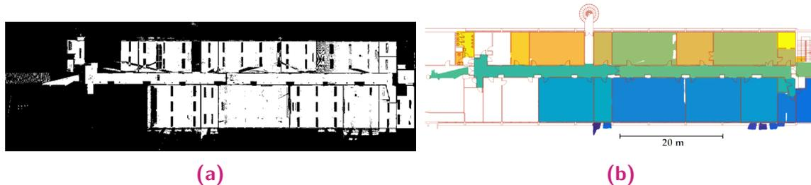
**Figure 2.1.:** Segmentation du nuage de points d'un étage de bâtiment par pièces par MACHER et coll. [Mac+17]. Images extraites de leur article. (a) Image binaire créée à partir des projections des points situés autour du plafond. (b) Résultat de la segmentation par croissance de régions. Le plan de l'étage est superposé (en rouge).
