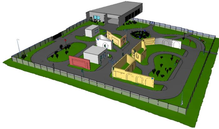
**Figure 3.17.:** Reconstruction schématique du site PAVIN. Un dispositif Velodyne est monté sur un véhicule qui réalise un parcours. La fréquence d'acquisition est 10 Hz.
