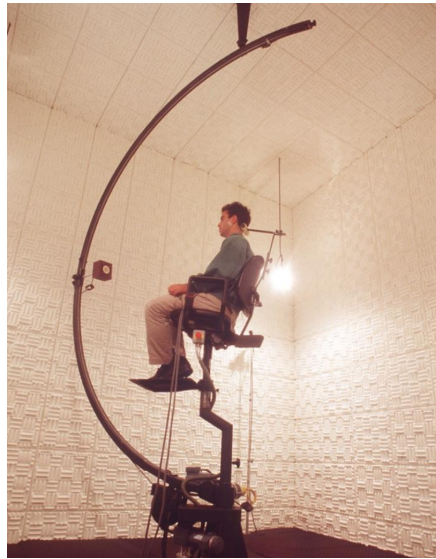
FIGURE 5.1 – Installation de mesure des HRTF à l'IRBA (extrait de [8])
