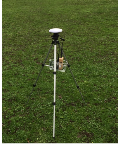
FIGURE 10.5 – Récepteur Base RTK, doté de son antenne dôme et d'un récepteur avec émetteur radio 433GHz pour l'envoi des corrections RTCM
