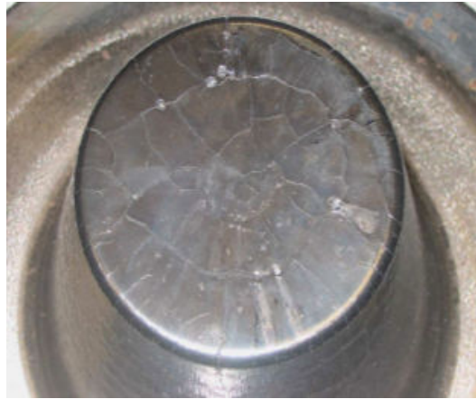
Figure 6 : Réseau de fissures, caractéristique du faïençage, lié à la fatigue thermique sur un poinçon revêtu de Stellite 6 après forgeage de 3000 pièces (ébauches de bagues de roulement) [FEKI10].
