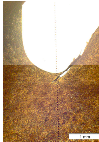
Figure 137 : Déchirement de l'acier.
