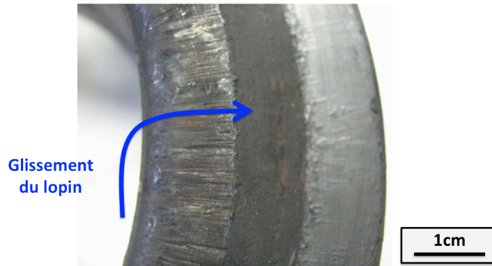
Figure 190 : Observation macroscopique en surface de la fuite de bavure sur la mini-matrice après mise en forme de dix lopins de hauteur 120 mm.
