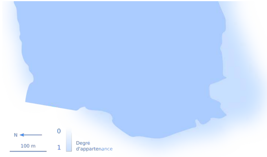
FIGURE 3.7 – Illustration de la modélisation du lac du Chambon à l'aide de la théorie des sous-ensembles flous. Extrait de BUNEL (2020).
