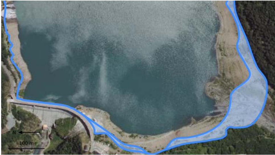
FIGURE 3.5 – Mise en évidence de l'incertitude pour la limite des hautes eaux. Extrait de BUNEL (2020).
