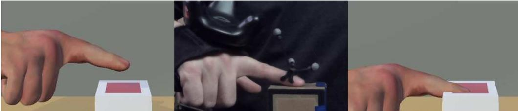
Figure 4: Divergences au contact tangible : lorsque l'utilisateur touche l'objet tangible (au milieu), il peut y avoir un écart virtuel (à gauche) ou une interpénétration virtuelle (à droite) entre le doigt virtuel et la surface de l'objet virtuel.
