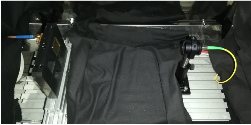
Figure 3.5 – Photo du banc expérimental dédié à l'étalonnage du photomultiplicateur. À gauche : le photomultiplicateur R11265-100 de l'entreprise Hamamatsu. À droite : la fibre optique connectée à un laser picoseconde "Pilas" (409 nm) de la société "Advance Laser Diode System" .
