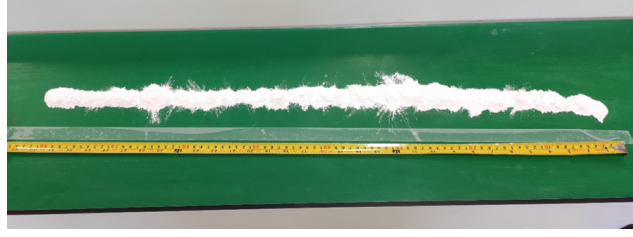
Figure 2.16 – Poudre co-broyée étalée sur une bande plastique pour la procédure de prélèvements. La bande d'environ 80 cm de long est divisée virtuellement en 40 compartiments de 2 cm de long chacun. Les prélèvements sont réalisés dans les compartiments qui sont tirés au hasard.
