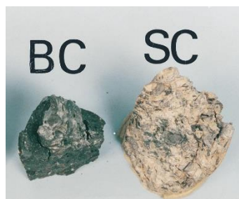
Figure 1.28 - Fracture de béton (éprouvette de 10 cm de diamètre et 20 cm de hauteur) de ciment au laitier à 91 jours de sous différentes conditions de cure, BC (Bath Cured) démoulé à 24 heures puis conservé dans eau à 23°C et SC (Sealed Cured) démoulé à 24 heures et conservé dans un sac fermé à 23°C (l'échelle de l'image n'est pas précisée par les auteurs) [56]
