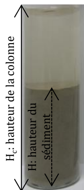
Figure 3.30 – Aspect visuel de la colonne de sédimentation du système OPC après 35 min d'analyse
