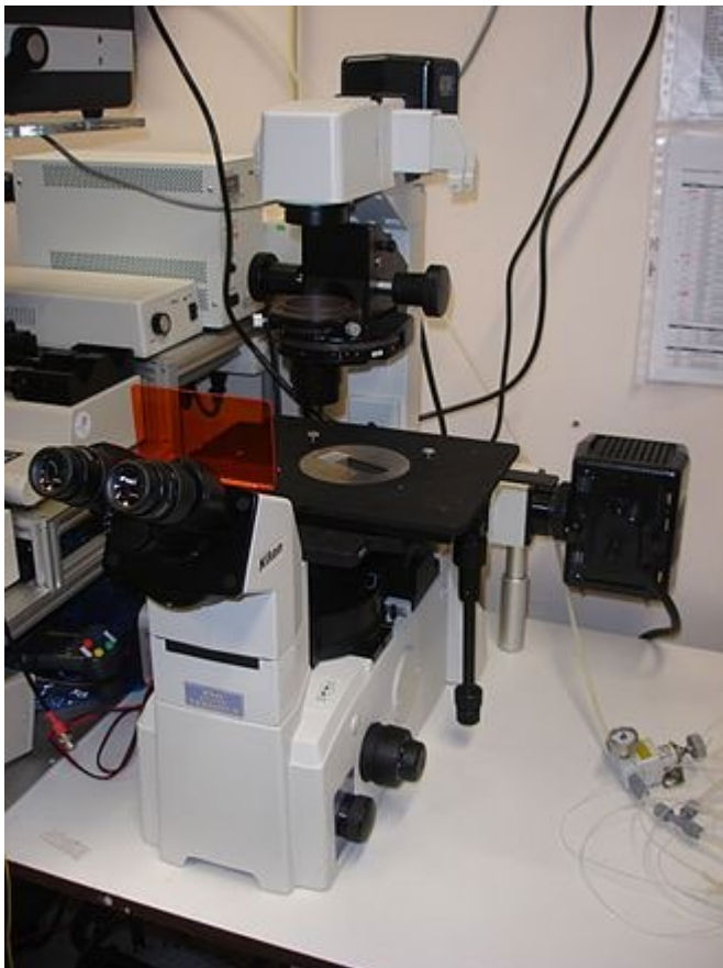
Microscope à fluorescence inversé (Nikon TE2000) ; la plaque orangée permet à l'utilisateur de regarder l'échantillon, tout en protégeant les yeux de la lumière UV qui excite la cible pour la rendre fluorescente.
