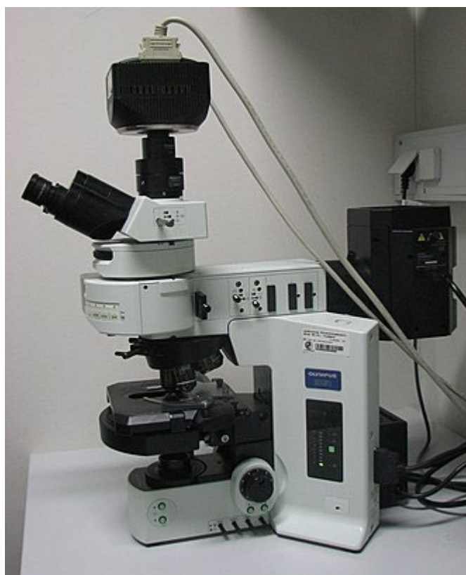
Microscope à fluorescence verticale (Olympus BX61), équipé de filtres et d'un appareil photo numérique.
