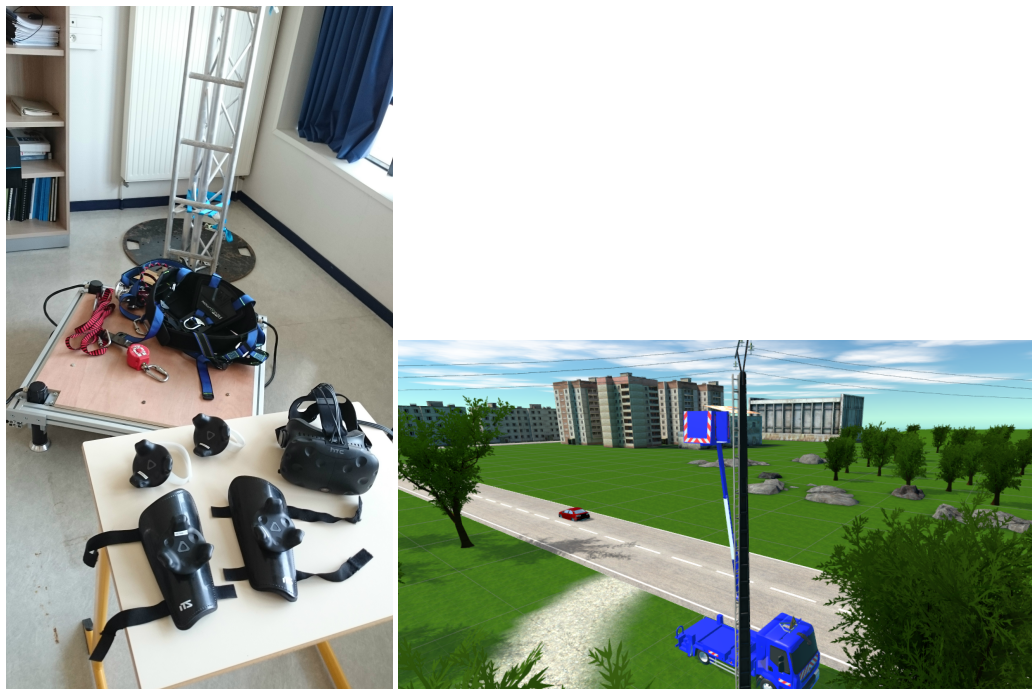
FIGURE 5.10 – A gauche, simulateur physique avec plateforme dynamique, échelle et harnais. A droite, environnement virtuel de simulation.
