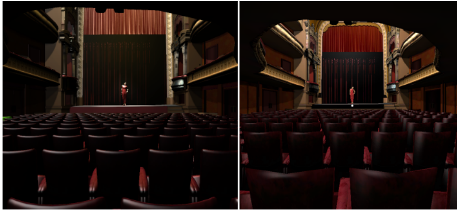
FIGURE 3.8 – À gauche : rendu dans le CAVE du théâtre Piccolo (245767 polygones). À droite : rendu dans le GearVR du même théâtre (82869 polygones).
