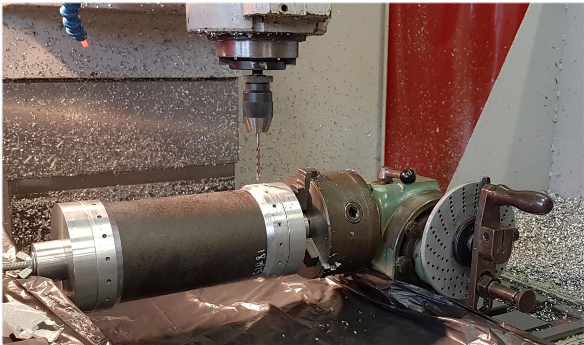
FIGURE A.6 – Opération de contre-perçage du tube composite après collage des talons usinés en alliage d’aluminium.
