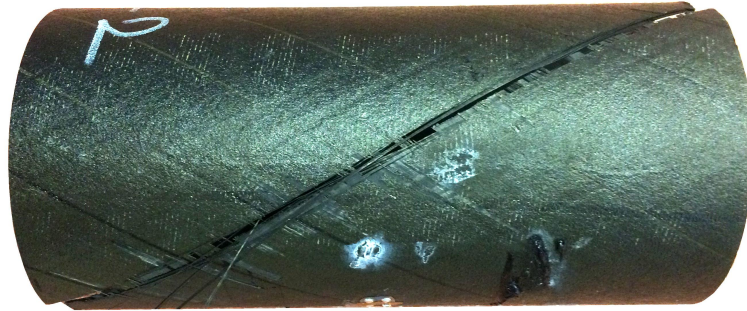
(a) Rupture brutale par propagation de la fissuration amorcée sur un bord.
