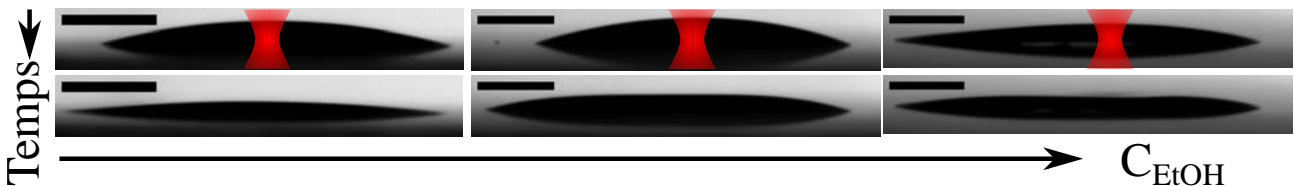
Figure 7.10 – Séquence d’images (barres d’échelle : 500 \mu\text{m} ) d’évaporation des gouttes binaires Eau-Ethanol de la figure 5.22 mais observées de côté.
