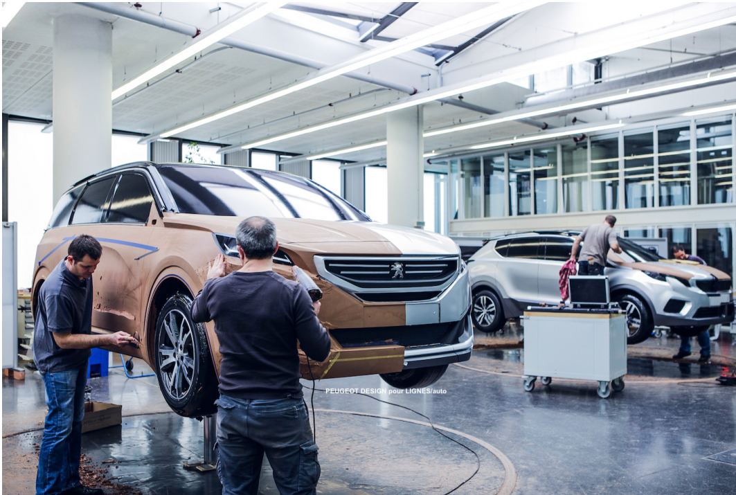
Figure 1.7 – Photo de maquettes en argile au Studio Extérieur Peugeot. Lorsque le modèle est assez avancé, des stickers sont appliqués pour imiter les différents matériaux. Photo : LIGNES/auto
