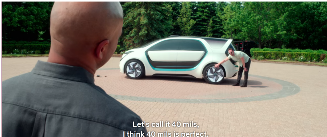
Figure 1.11 – Lors de cette revue de design, le décideur (Ralph Gilles) demande à déplacer le passage de roue arrière. Le déplacement est quantifié de manière précise (40mm) mais son impact sur la forme du véhicule ne peut être estimé que par le déplacement d’une texture. (extrait de Abstract : The Art of Design , par Netflix).
