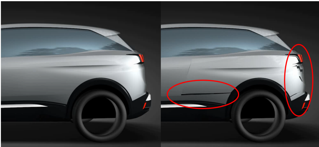
Figure 1.10 – La modification de la ligne de flanc entraîne également des discontinuités dans le modèle.
