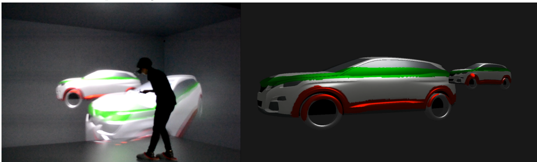
Figure 6.10 – Version finale du démonstrateur avec affichage du véhicule à échelle 1 :1 ainsi que de son modèle réduit à échelle 1 :5. L'utilisateur peut plus facilement et rapidement peindre sur ce modèle réduit et observer l'effet de la déformation sur le modèle à taille réelle, situé à 3m du centre du système immersif.
