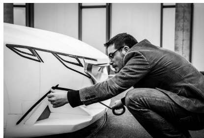
Figure 1.12 – Un designer définit de nouvelles lignes à l’aide du tape sur une maquette physique. Photo : Peugeot Design Lab
