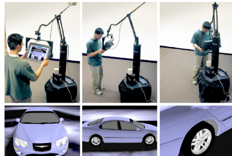
Figure 2.1 – Le BoomChameleon de Tsang et al. [11] permet de naviguer autour d'un objet virtuel tout en l'annotant.
