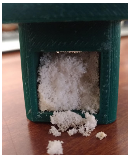
FIGURE 4.28 – Échantillon de mousse d'alumine détruit après la première hydratation
