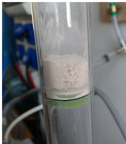
FIGURE 5.26 – Mise en évidence de passages préférentiels dans la colonne d'hydratation
