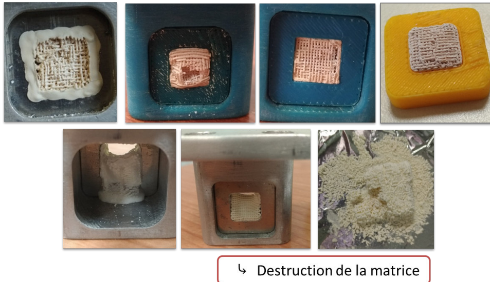
FIGURE 4.22 – Destruction partielle ou totale des matrices entrainant une perte de matériau et tenue mécanique de la structure du composite
