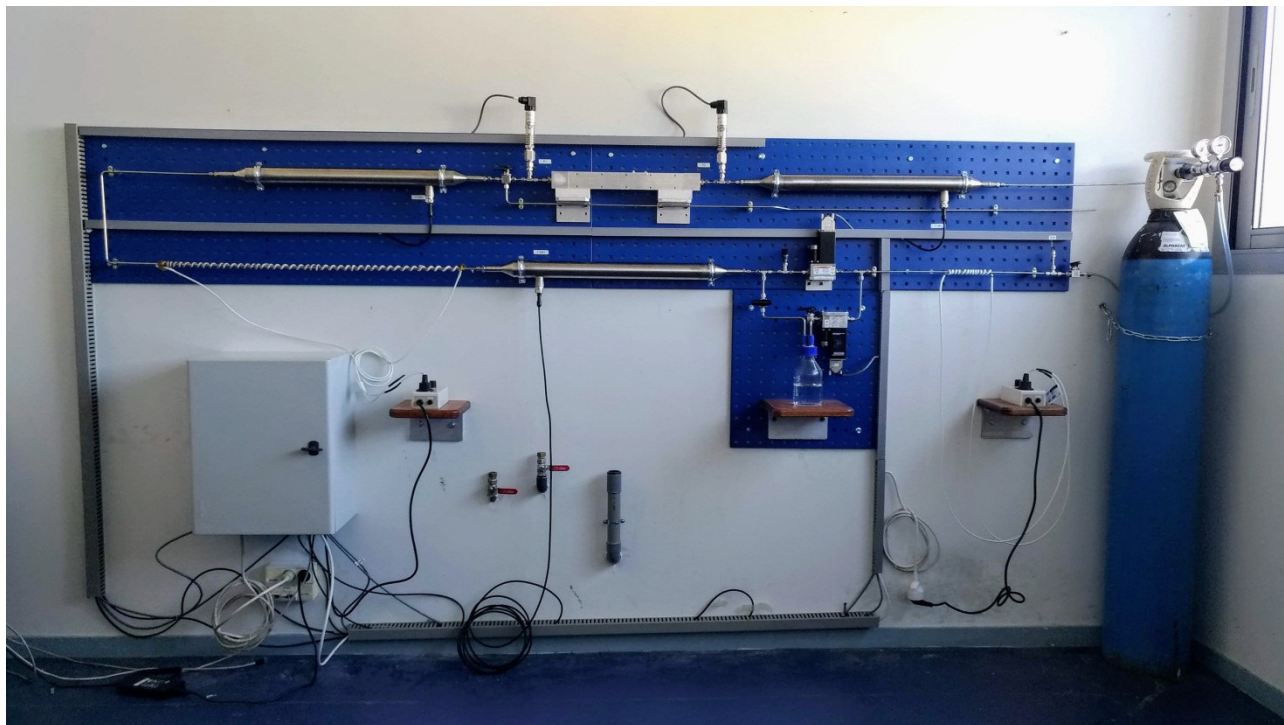
FIGURE 3.20 – Montage du banc expérimental avant isolation
