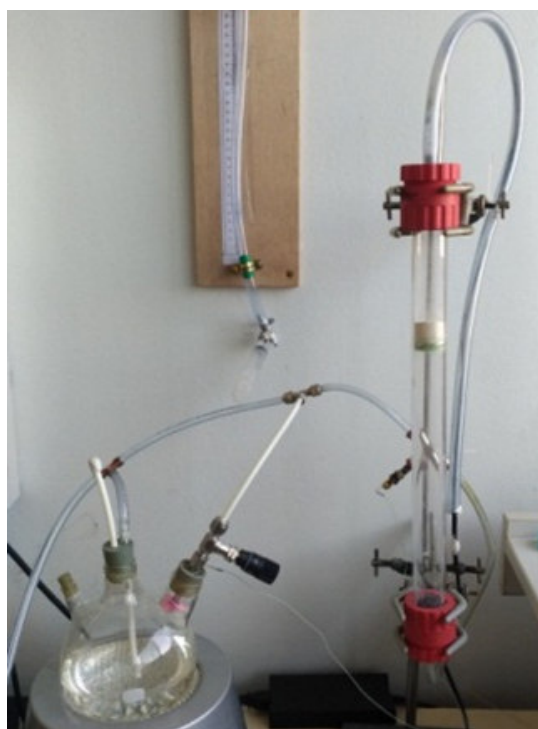
FIGURE 5.24 – Photographie de l'humidificateur et la colonne d'hydratation
