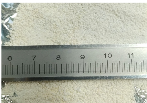
FIGURE 4.3 – Taille des cristaux de poudre de LaCl_3
