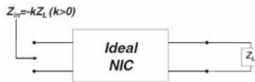
Figure 74 : Illustration du montage NIC
