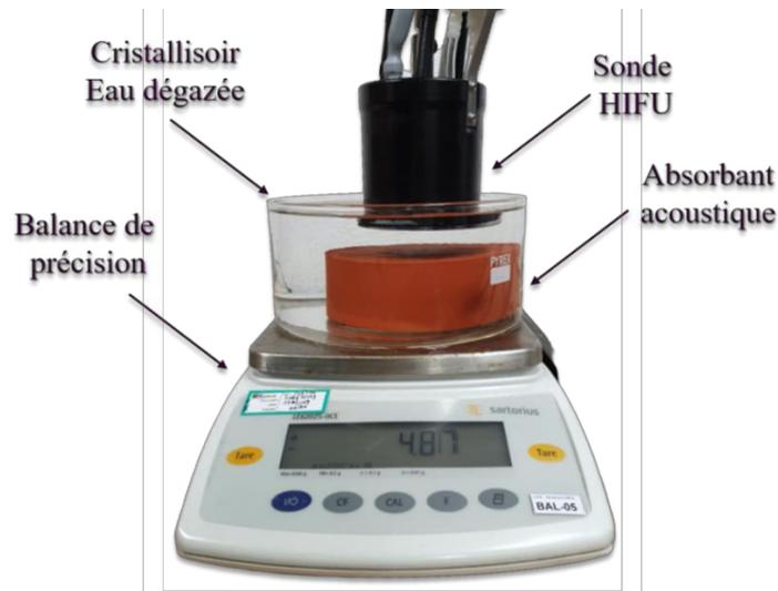
Figure IV.33. Sonde HIFU en place lors d'une mesure de poussée acoustique réalisée par la méthode Davidson.
