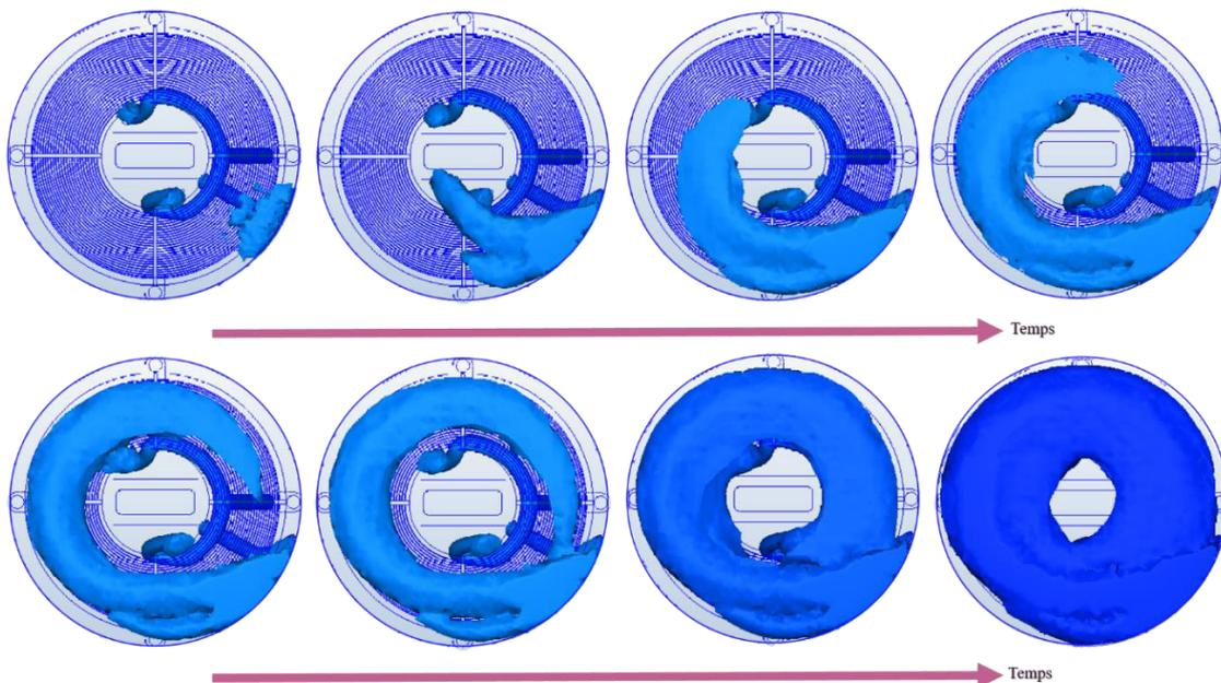
Figure IV.19. Résultats numériques de la génération et de l'évolution du vortex par les isosurfaces correspondant au volume du fluide.
