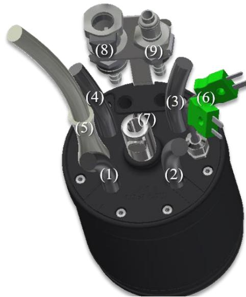
Figure IV.23. (1,2,3,4) sorties des câbles puissance. (5) Câble d'imagerie. (6) Sortie thermocouple. (7) Préhenseur mécanique. (8) Arrivée du fluide de refroidissement. (9) Sortie du fluide de refroidissement.
