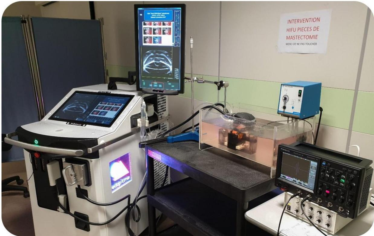
Figure II.4 . Photographie du montage expérimental. Sur la gauche se trouve le prototype M Sonic auquel est connectée la sonde HIFU. Au centre se trouve la cuve contenant l'échantillon maintenu dans son support ainsi que le transducteur de caractérisation, le réflecteur et au-dessus la sonde HIFU. Sur la droite se trouvent le générateur et l'oscilloscope utilisé pour les mesures acoustiques.
