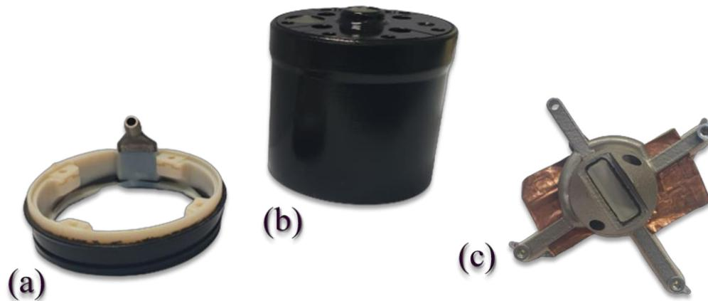
Figure IV.22. (a) Partie basse du boîtier avec le diffuseur collé. (b) Partie haute du boîtier et son couvercle. (c) Support de la sonde échographique avec la sonde en place.
