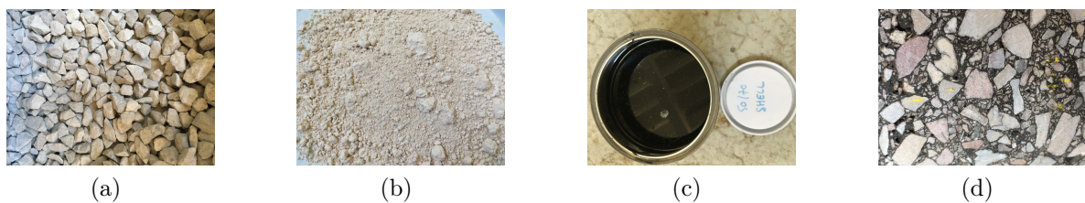
FIGURE 2.2 – Composants principaux des bétons bitumineux : (a) granulats, (b) fine, (c) bitume et (d) exemple de béton bitumineux
