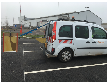
FIGURE 2.9 – Exemple d’un radar à sauts de fréquence mono-statique embarqué sur un véhicule (Cerema).
