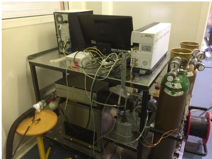
Figure 29 : Ligne d'échantillonnage et d'analyse des gaz
