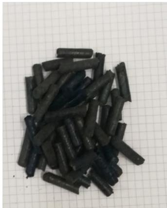
Figure 23 : Traceurs colorés utilisés pour la détermination du temps de séjour
